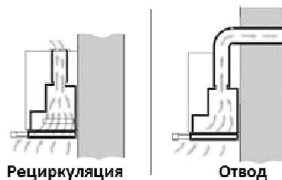
В режиме рециркуляции (фильтрующий) вытяжка не подключается к вентиляционной шахте. Засасываемый загрязненный воздух проходит через систему угольных фильтров, которые устанавливаются в корпус вытяжки, и подается очищенным обратно в помещение.
