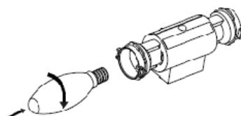
Вытяжка оснащена лампами накаливания. Чтобы заменить осветительную лампу, необходимо снять алюминиевый фильтр, выкрутить старую неисправную лампу и заменить новой. Вместо старой лампы необходимо обязательно установить лампу с таким же номиналом мощности и установить алюминиевые фильтры обратно.
