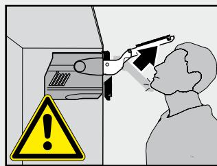
Существует опасность получения травмы при выскакивании рычага!
