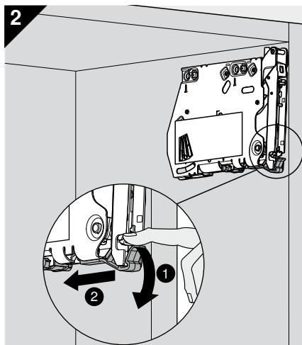
Снимите транспортировочное крепление
