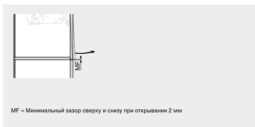
MF = Минимальный зазор сверху и снизу при открывании 2 мм
