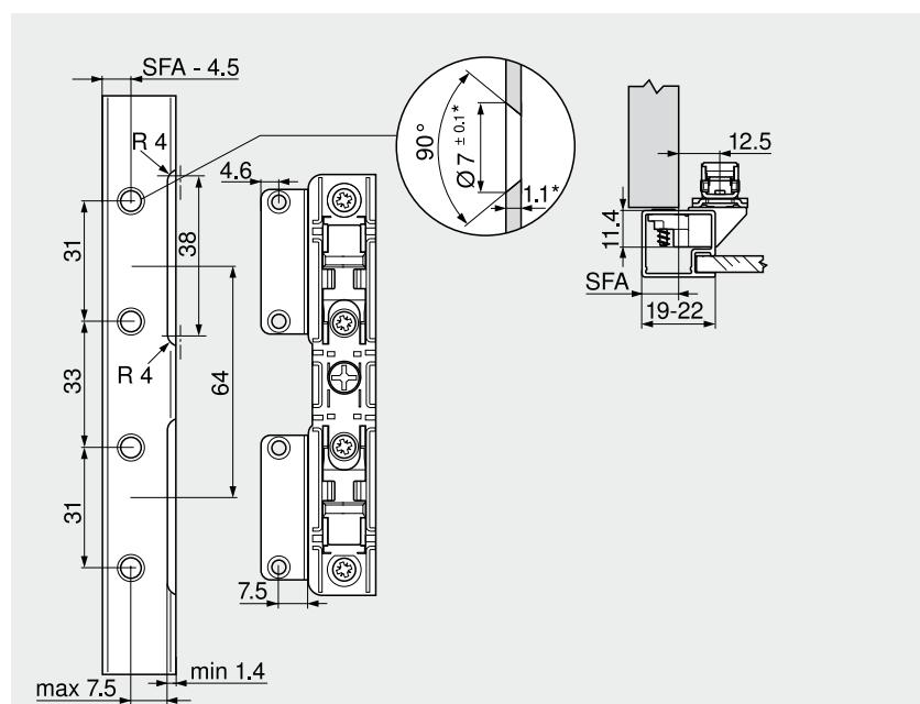
При ширине рамки 19 мм возможно SFA 11 – 18 мм
