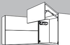
Чтобы избежать столкновения фасадов, приводы (макс. 6 шт.) настраиваются таким образом, чтобы можно было открыть только один подъемник. Подъемник невозможно будет открыть кнопкой до тех пор, пока будет открыт связанный с ним другой подъемник.
