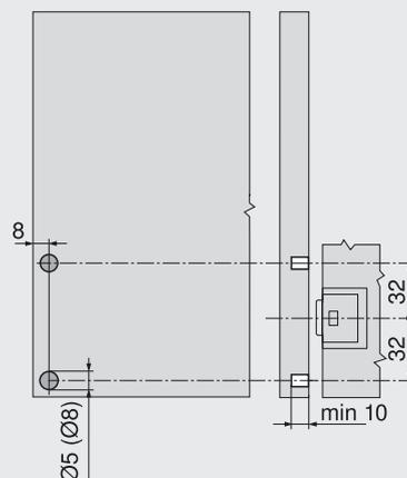
Мы, как правило, рекомендуем устанавливать 4 дистанционных амортизатора Blum рядом с кнопкой. Для определенных конструкций (с высокими или легкими фасадами) иногда достаточно бывает двух дистанционных амортизаторов Blum. Рекомендуется пробная установка.
