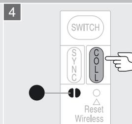
Нажать на кнопку <COLL> на втором приводе, пока LED-индикаторы на двух синхронизируемых приводах не будут гореть непрерывно
