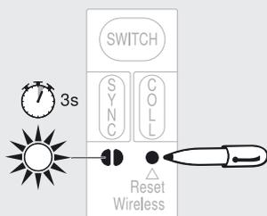
Нажать кнопку <Reset Wireless> при помощи шариковой ручки и удерживать ее (мин. 3 сек), пока LED-индикатор не замигает с большой частотой.
