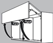
До трех приводов можно настроить таким образом, чтобы они работали синхронно. Эта функция необходима, когда несколько корпусов имеют один общий фасад.
